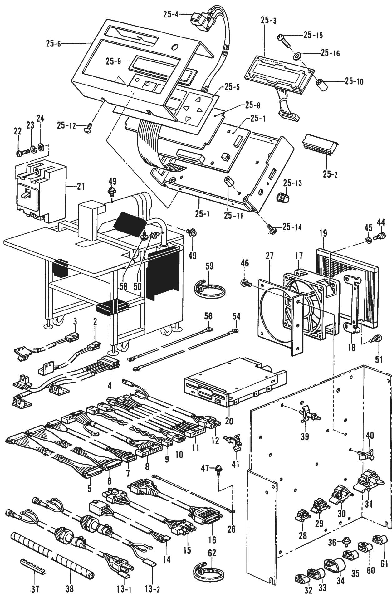
Q2. 電装品関係 / Power supply equipment mechanism / Stromversorgung / Mécanisme de l'équipement en alimentation électrique / Mecanismo del equipo de alimentación de corriente
