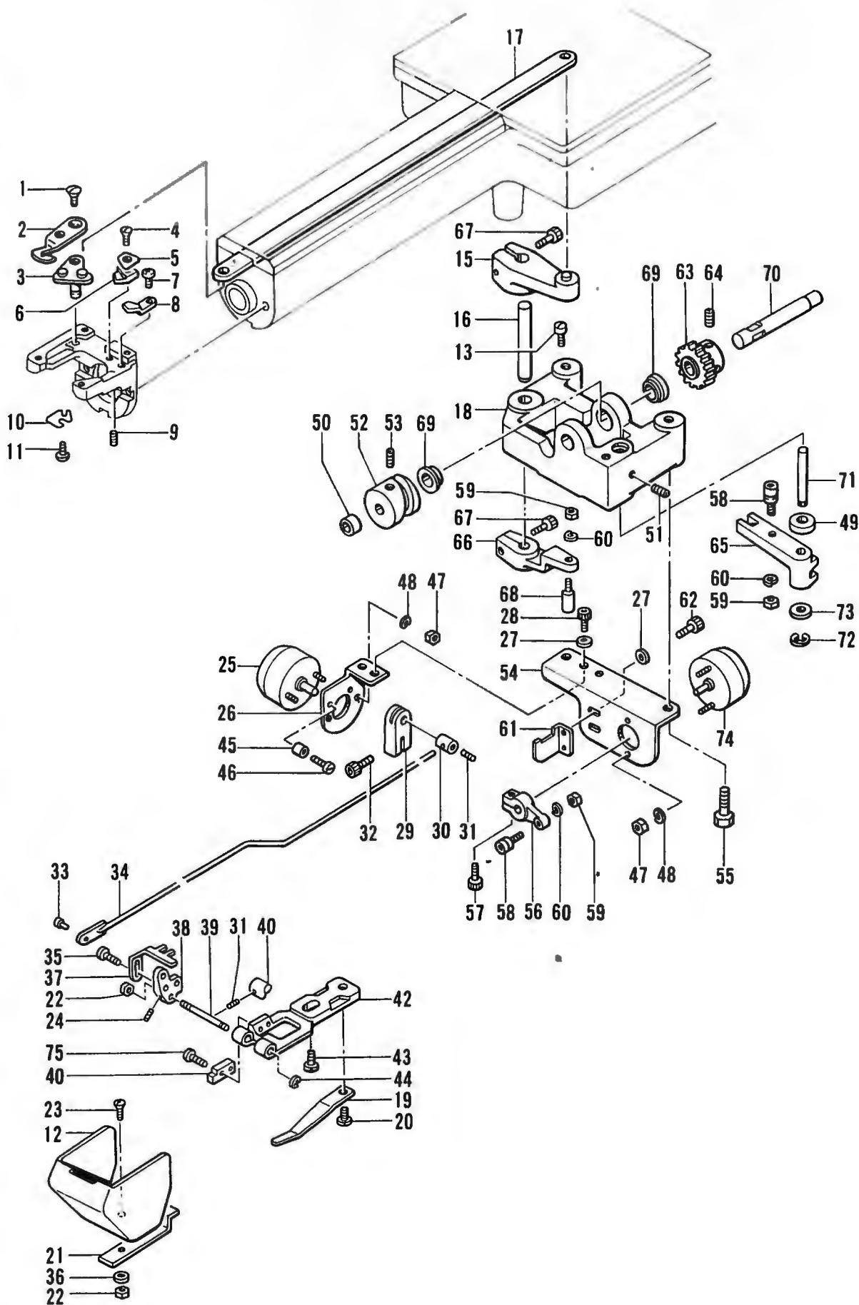
E. 糸切り関係/Thread trimmer mechanism/Fadenabschneidevorrichtung/
