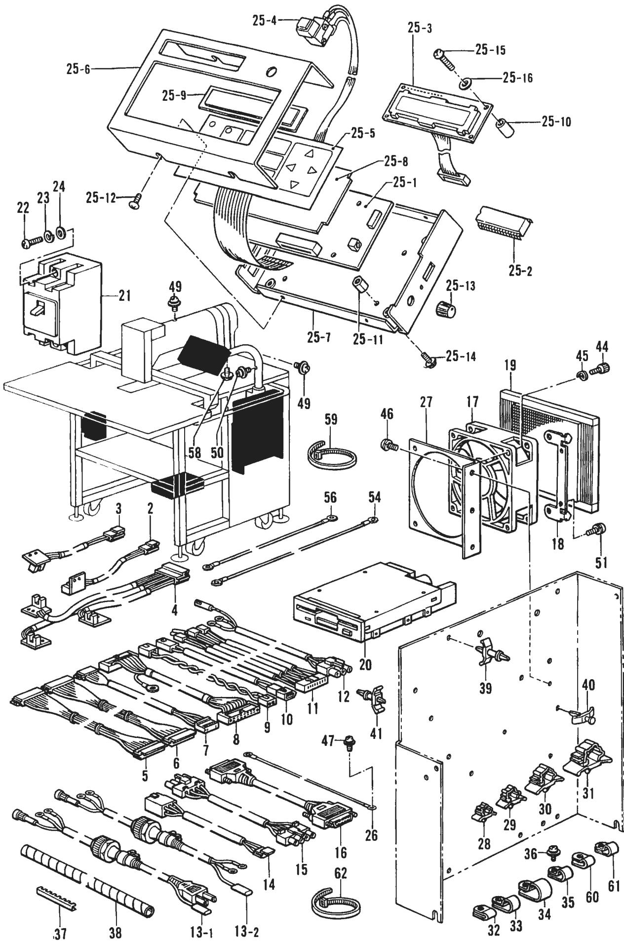
**Q2. 電気品関係 / Power supply equipment mechanism / Stromversorgung / Mécanisme de l'équipement en alimentation électrique / Mecanismo del equipo de alimentación de corriente**
