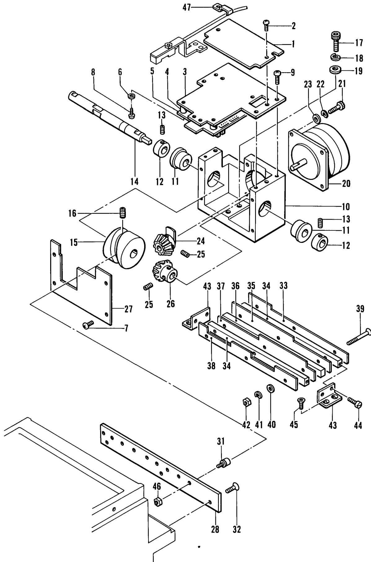
F. 針棒切替操作関係 /Needle bar flip-up mechanism /Nadelstangehochstellung /
