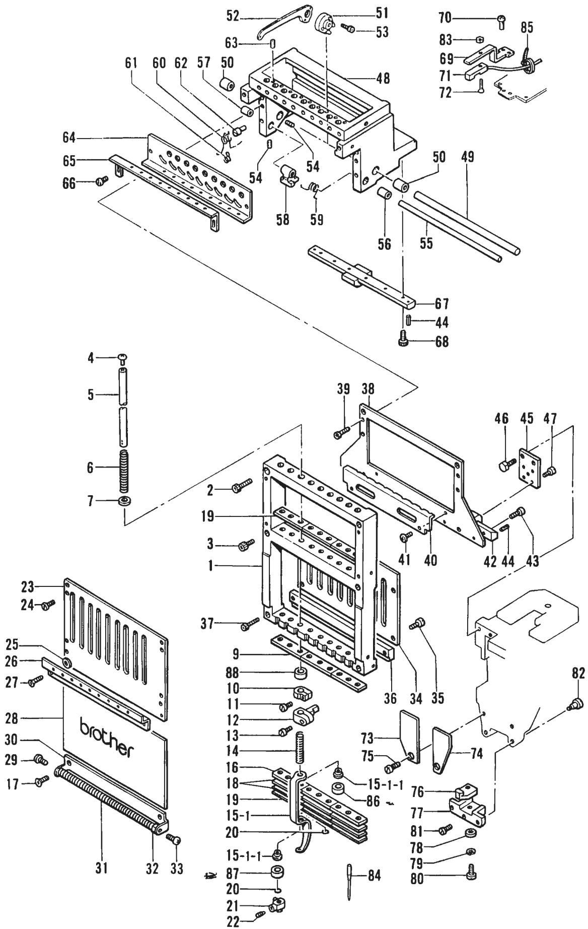
B. 針棒関係 / Needle bar mechanism / Nadelstangenvorrichtung /
