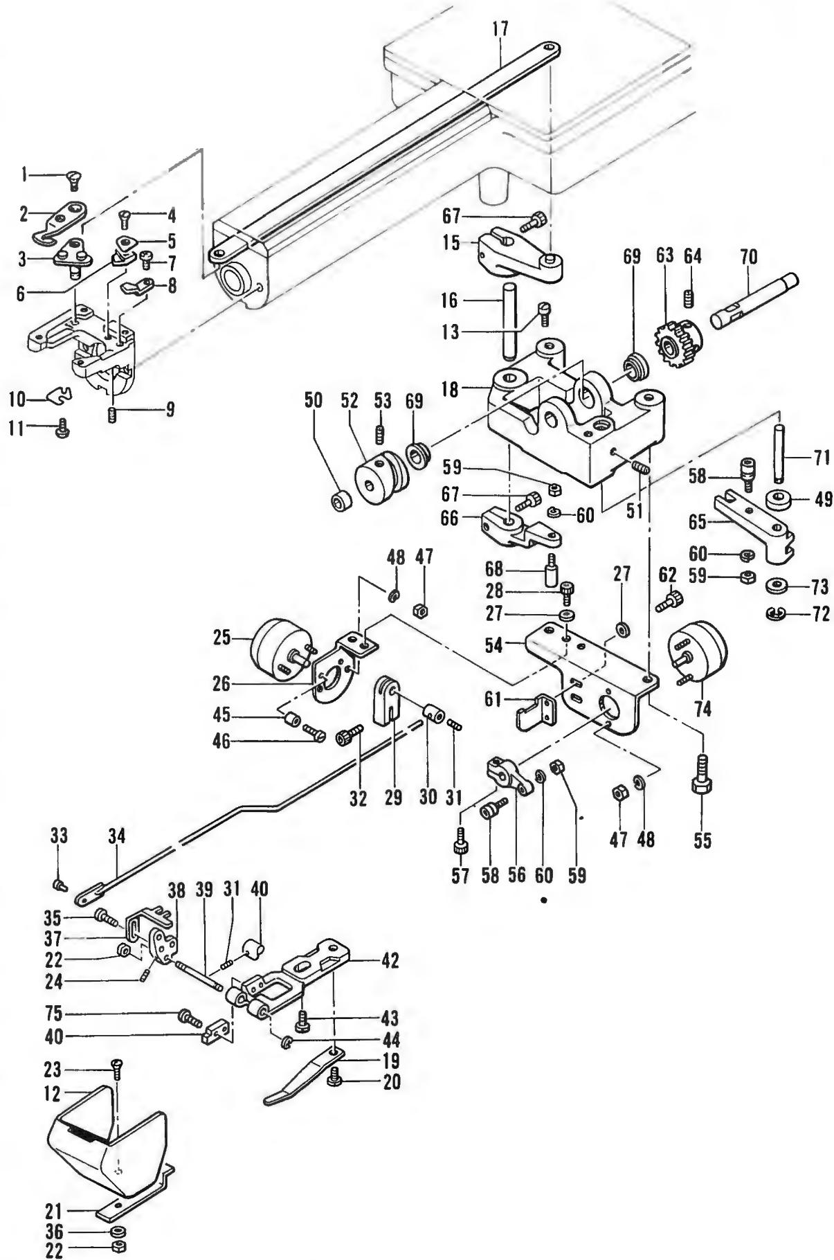
E. 糸切り関係 / Thread trimmer mechanism / Fadenabschneidevorrichtung /
