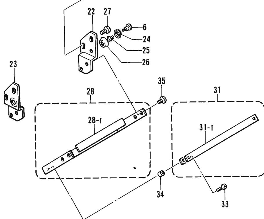
D. 糸拭イ関係 / Thread wiper mechanism / Fadenwischvorrichtung /
