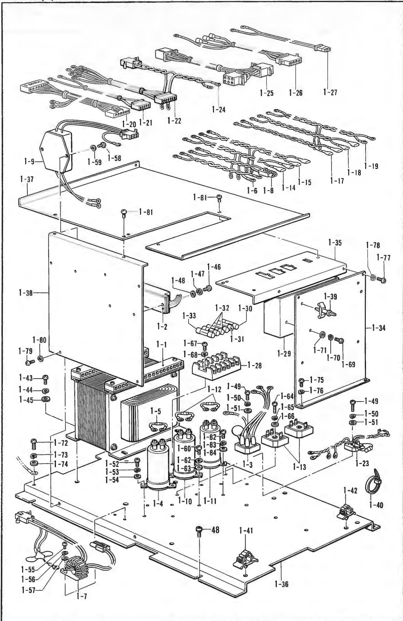
Q1. 電気品関係 / Power supply equipment mechanism / Stromversorgung / Mécanisme de l'équipement en alimentation électrique / Mecanismo del equipo de alimentación de corriente
