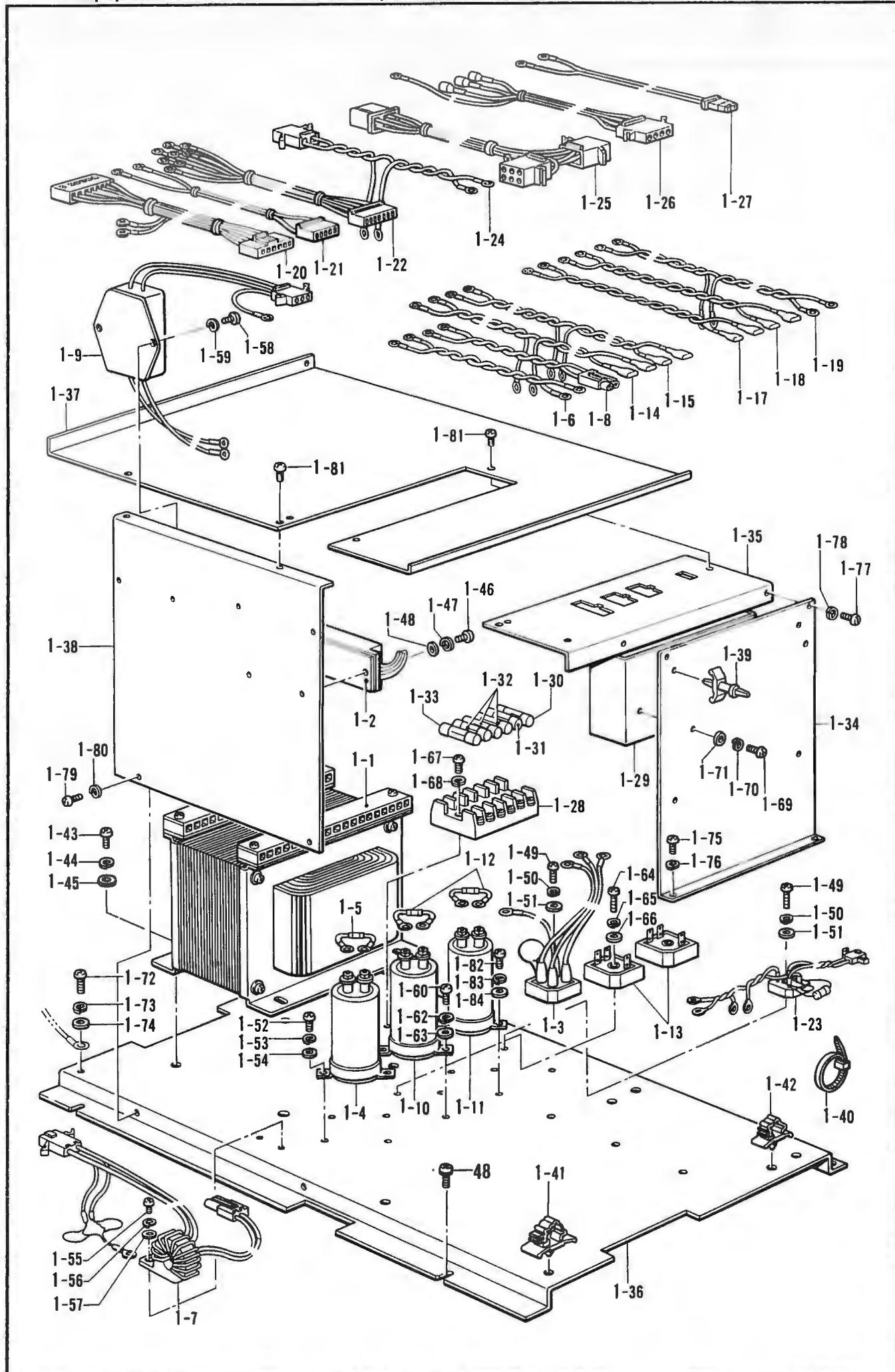
Q1. 電装品関係 / Power supply equipment mechanism / Stromversorgung / Mécanisme de l'équipement en alimentation électrique / Mecanismo del equipo de alimentación de corriente
