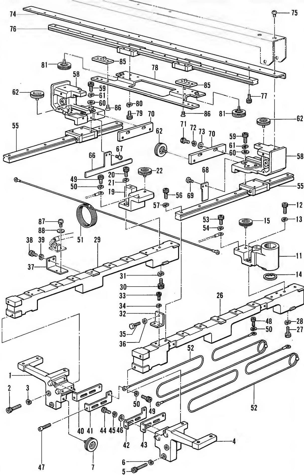
M. 送り・案内関係 / Feed guide mechanism / Transportführung /
