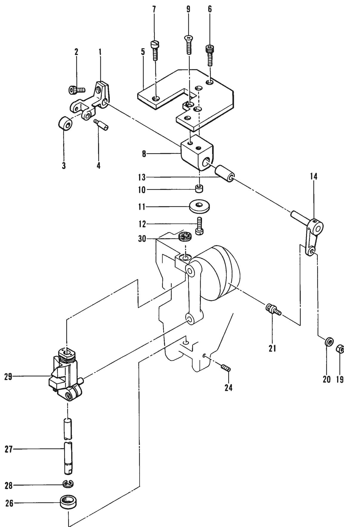
C. 針棒駆動関係/Needle bar and driving clutch mechanism/Nadelstange und antriebskupplung/Barre à aiguille et mécanisme d'embrayage d'entraînement/Barra de aguja y mecanismo de embrague de mando
